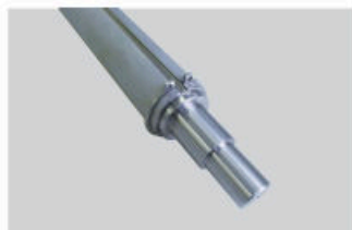
①軸端部溝にスナップリングを入れる
