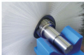
③ブラシはネジ部分を少し残した状態まで挿入する
