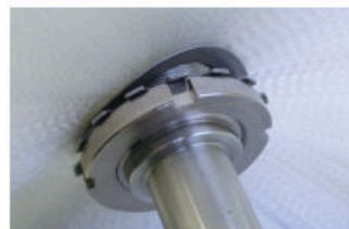
④菊ワッシャー、締め付けナットの順に入れ締め付け固定(完了)
