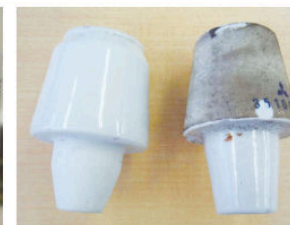
(右) 使用済みの汚れた碓子 (左) ブラッシング洗浄後の碓子
