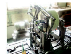
動釣合計測機 稼働回転数で 10g以下に修正 します。
