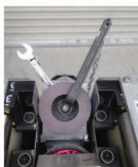
ディスクの交換は付属スパナで簡単に行えます。
